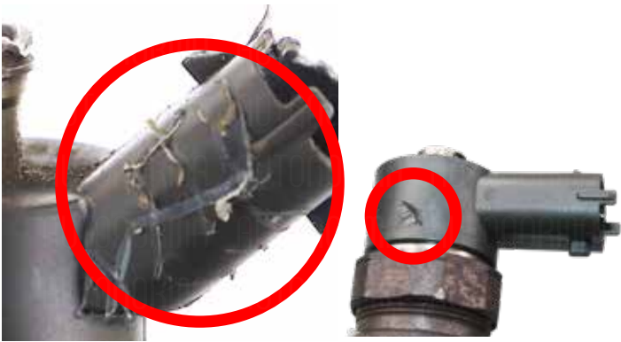
Connecteur endommagé – rayures
